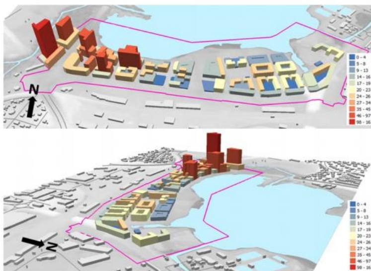
Figur 12. Illustration av klimatpåverkan från grundläggning och masshantering. Bild: Statens geotekniska institut, 2017.
